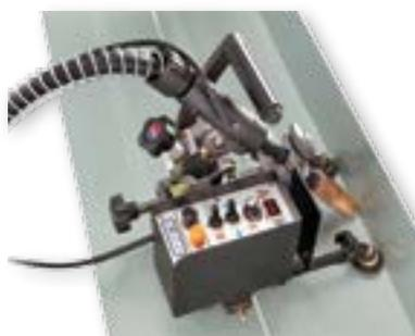
Svařovací strojek **CS-71** je vysoce kvalitní a spolehlivý svařovací traktor zajišťující posun svařovacího hořáku nastavenou rychlostí. Strojek je určen pro svařování koutových svarů v horizontální poloze. Strojek je možné propojit se svařovacím strojem pro plně automatizovaný proces. Traktor je možné nastavit pro stehování. Silný magnet zajišťuje pevné spojení se svařencem a tím dobrou trakci.
