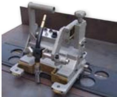
**HK-6A a HK-6A-D** jsou svařovací traktory s držákem hořáku. Jednoduchá a odolná celokovová konstrukce předurčuje použití strojku v náročných provozech. Strojek má nastavitelný držák hořáku v několika směrech tak, aby s ním bylo možné svařovat koutové ale i rovné sváry. V provedení HK-6AD je vodící kolejnice o délce 2x 1,8 m (další kolejnicové moduly lze doobjednat na požadovanou délku). Použití strojku zvyšuje efektivitu a kvalitu výroby a tím i umožňuje snížení nákladů výroby.
