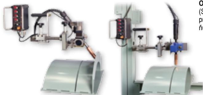
Oscilátor R1 a Pendl R1 jsou programovatelné držáky svařovacích hořáků, které umožňují kývavý (S1 Weaver) nebo lineární (R1 Weaver) pohyb hořáku dle požadavků. Toto řešení se využívá např. pro výplňové svařování. Použití strojků výrazným způsobem zvyšuje efektivitu a kvalitu výroby a tím umožňuje snížení nákladů na výrobu.
