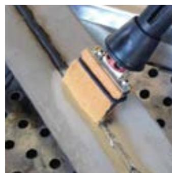
Vyměnitelná elektroda vyrobená z uhlíku, nebo wolframu potažená tamponem určená pro větší plochy.
