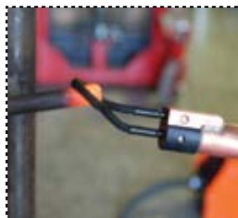
**DHI3-F1** zahřeje šroub M12 nebo matici na teplotu až 800°C do 15 vteřin. Příprava použití je podstatně rychlejší než příprava autogenní soupravy. Zapojením ohřevu do zásuvky 1x 230 V, přiložením indukčního hořáku na ohřívání díl a zmáčknutím ovládacího tlačítka ihned začíná proces indukčního ohřívání. Ohřívání díl je velmi rychle ohřátý dle potřeby až do „ruda“.
