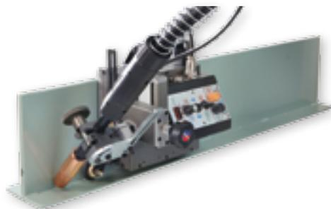
**CS-41** je uzpůsoben ke svařování koutových svárů úzkých profilů, kde je šířka základny od 10 mm a výška stěny od 120 mm. Silný vypínatelný magnet drží strojek ve svislé poloze a vodící kladky udržují potřebný směr strojku a hořáku. Strojek má nastavitelný držák hořáku v několika směrech. Samozřejmostí je možnost nastavení rychlosti pojezdu, dále času vyplnění kráteru na začátku a konci svařovacího procesu.
