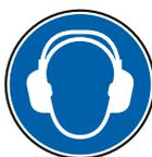
Bei der Bearbeitung von Werkstücken kann je nach Werkstück/Material der Lärmpegel über 85 dB(A) liegen. Verwenden Sie deshalb einen geeigneten Gehörschutz!
