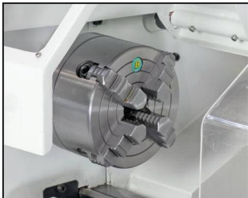
**Anmerkung:** Zur Montage des 4-Backenfutters wird ein zusätzlicher Futterflansch benötigt.
